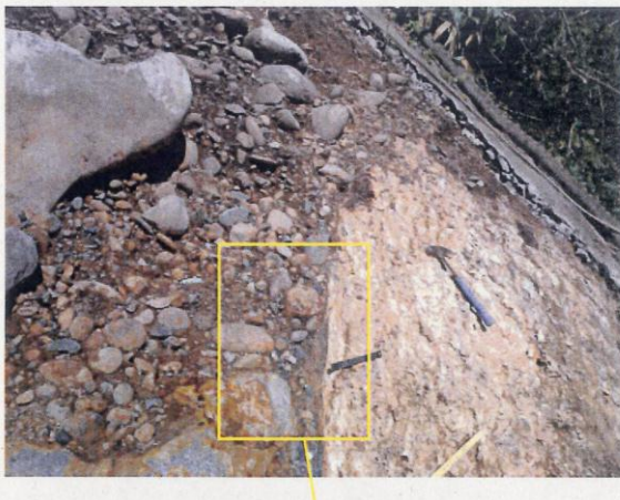
写真 5.1.31 黄矢印で示す断層面に擦痕は確認されない。
